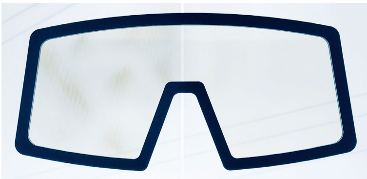
Bild: [25-01_02]: „Pureness“: sedak tempered+ ist das erste vorgespannte Glas ohne Anisotropien (rechts); zum Vergleich links konventionell, vorgespanntes Glas.
